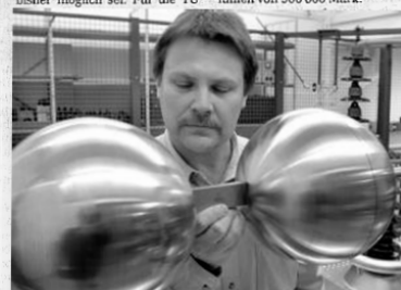
Techniker Michael Stark richtet eine Messkugel-Funkenstrecke ein im Hochspannungslabor der TU Chemnitz. Fotos (2): AP
